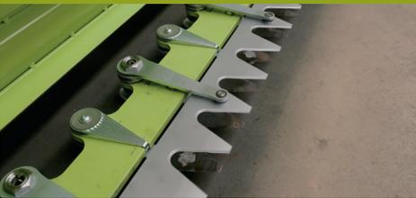
Mit dem Doppelmessermähwerk lassen sich heute Arbeitsbreiten bis 10 m mit wenig Traktorleistung und geringem Gewicht realisieren. Der saubere Scherenschnitt begünstigt einen schnellen Wiederaufwuchs.
